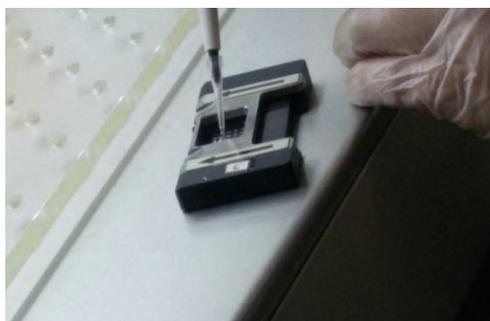
Рисунок 2.2.3.1.2.1 - Микрочип с лиофилизированными в микрореакторах компонентами ПЦР-смеси
