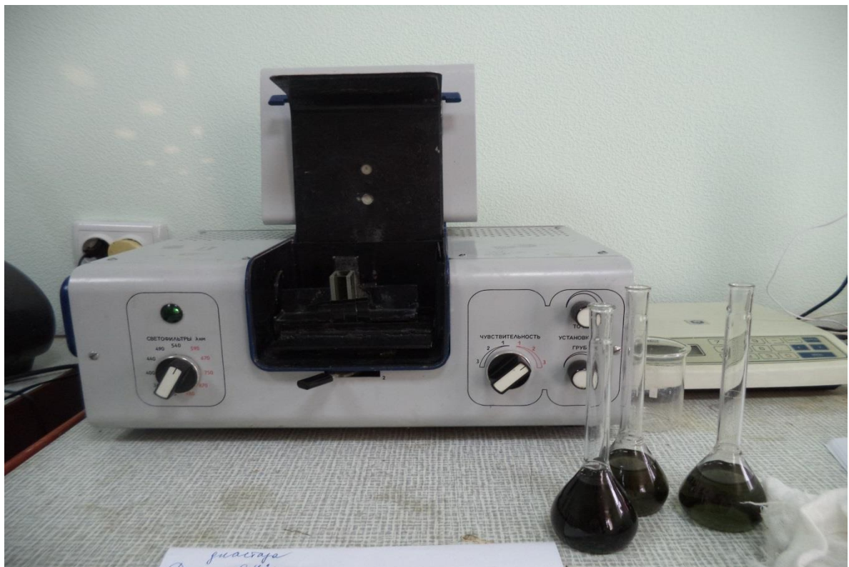
Рисунок 9 - Измерение оптической плотности на фотоэлектроколориметре
