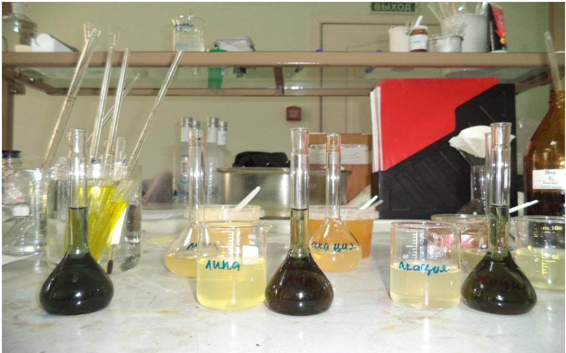
Рисунок 8 - Реакционная смесь после добавления раствора йода при определении диастазного числа
