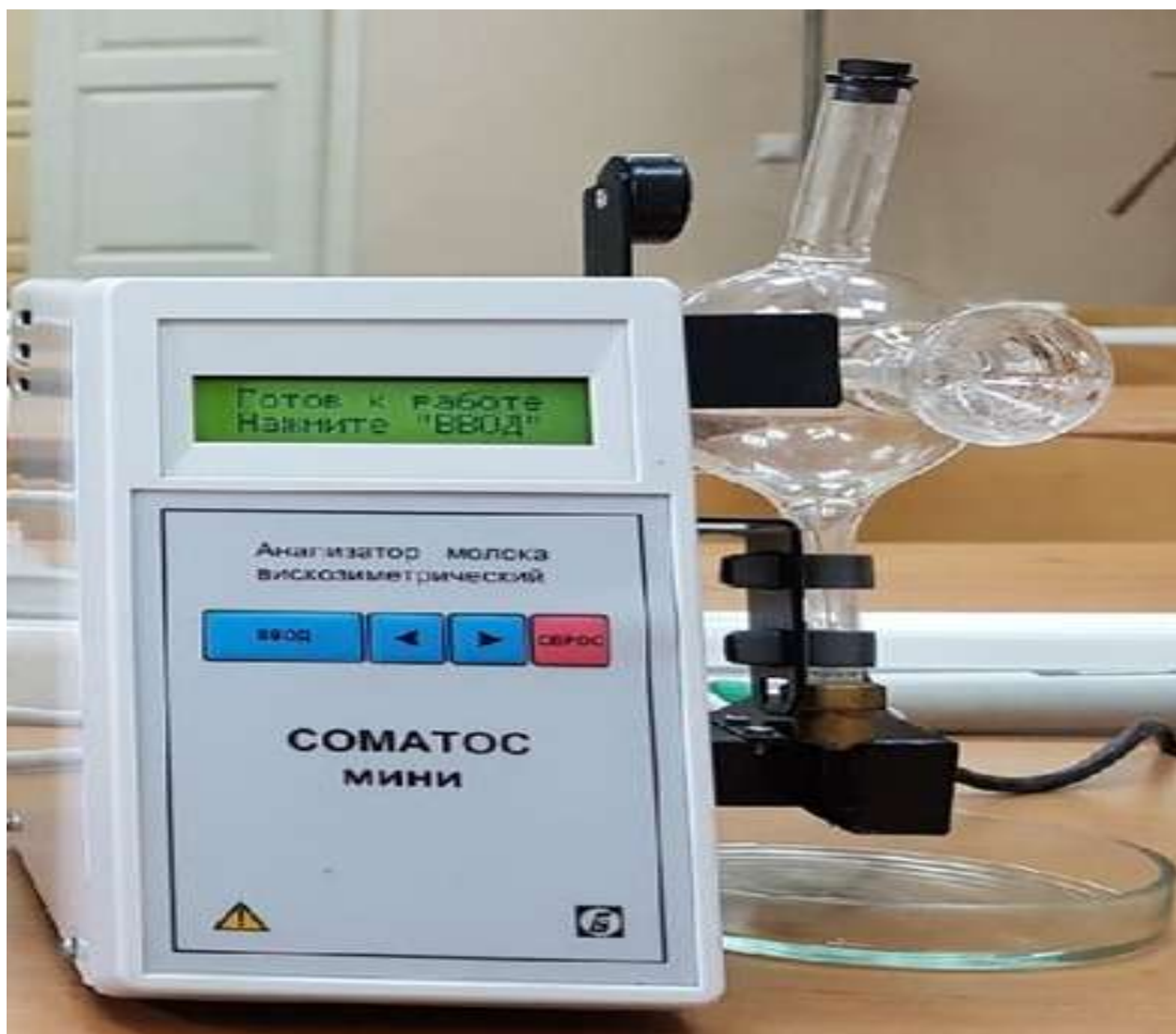
Рисунок 1 – Соматос - Мини 2.05 перед началом оценки количества соматических клеток в секрете вымени вискозиметрическим способом
