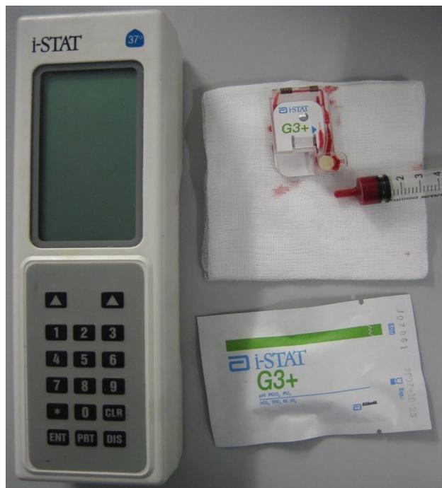
Рисунок 6 – Портативный газоанализатор I-STAT (фирмы Abbott, Канада).
