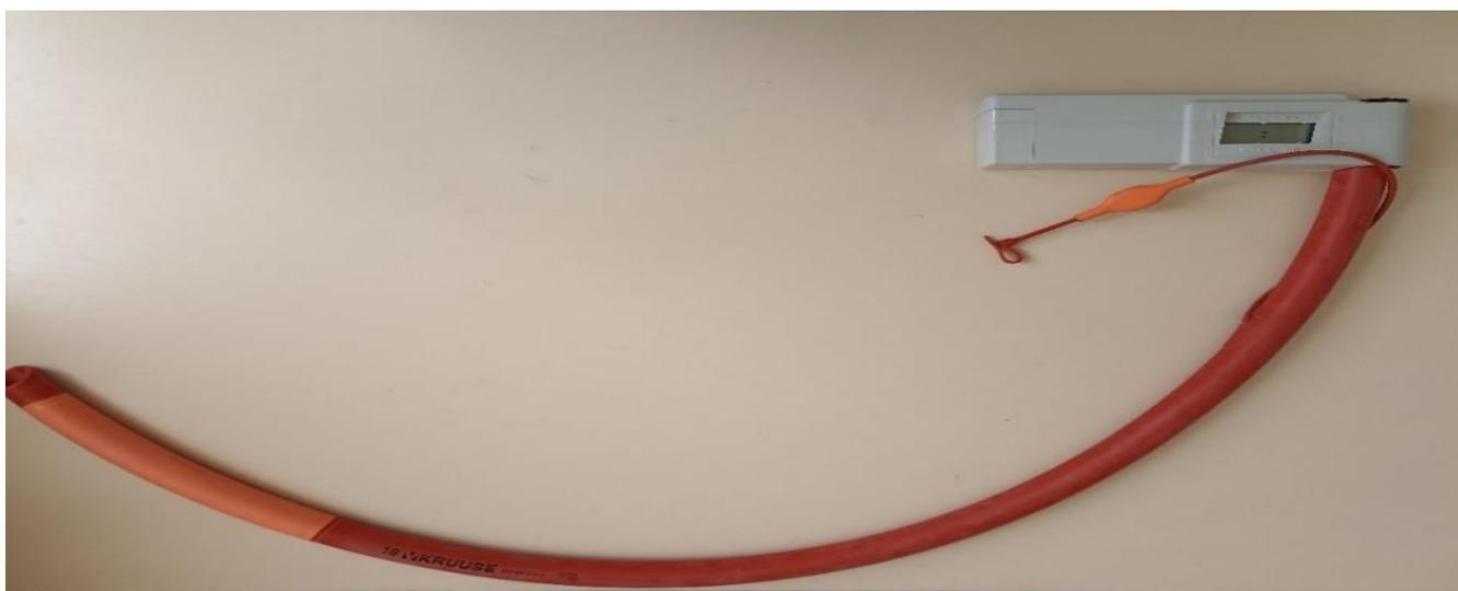
Рисунок 5 – Спиротест УСПЦ-01, подсоединённый к интубационной трубке.
