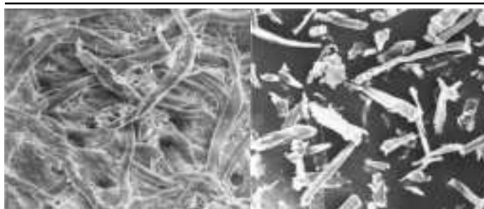
Рис. 1. Растровые электронные фотографии целлюлозных образцов: а – волокна целлюлозы, б – частицы микрокристаллической окисленной целлюлозы
