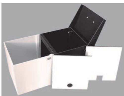
Фото 7. Установка «Темно-светлая камера» для мышей
