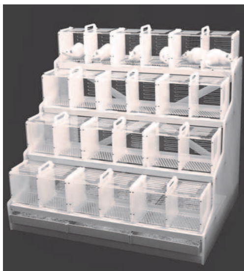
Фото 1. Комплект оборудования для индивидуальной рассадки 24 крыс
