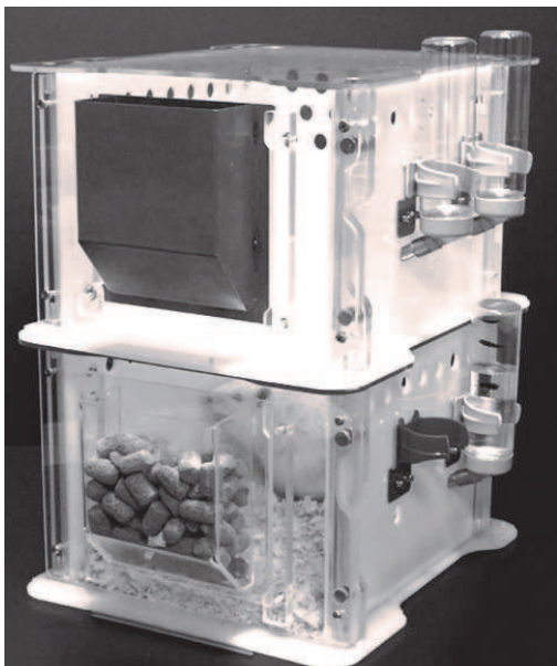
Фото 4. Камера для индивидуального содержания крыс
