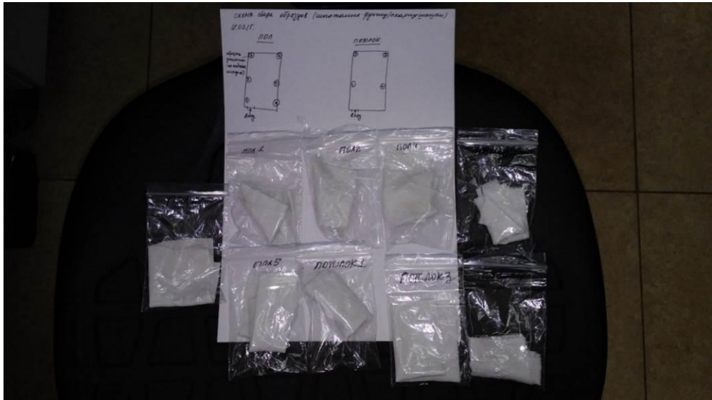
Рисунок 34. Подготовленные лоскуты ветоши для определения остатков действующих веществ и схема расположения лоскутов в помещении, оригинал
