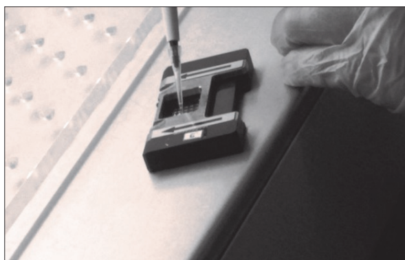
Рисунок 1. Микрочип с лиофилизированными тест-системами в микрореакторах.
