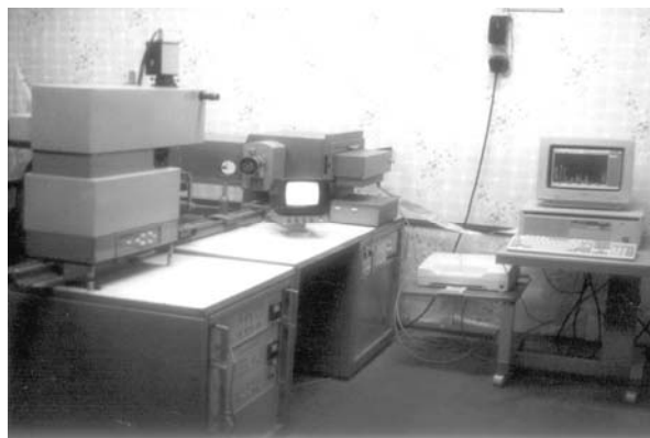
Рис. 2. Внешний вид установки лазерного микроанализа «Спектр-2000»
